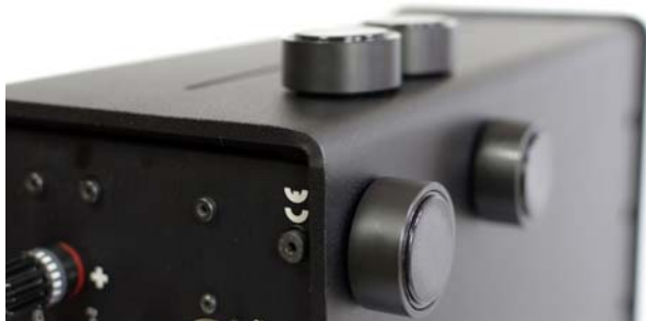
Die Gerätefüße der Ascendo-Endstufe haften magnetisch
