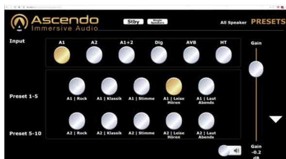
Blick auf das Webinterface der Ascendo-Endstufe: In Kürze wird man hierüber die Lautstärke regeln und Klanganpassungen vornehmen können
