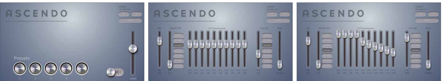
Das GUI läuft auf jedem Browser und Betriebssystem. Am bequemsten ist natürlich die Bedienung auf einem Tablet. Auf der Startseite stehen fünf Presets zur Auswahl, um den Klangcharakter des Subwoofers schnell zu verändern. „Switch Page“ verändert die Ansicht und ermöglicht dann umfangreiche Manipulationen des SMS G15, um den Subwoofer an den Hörgeschmack oder die Raumakustik anzupassen
