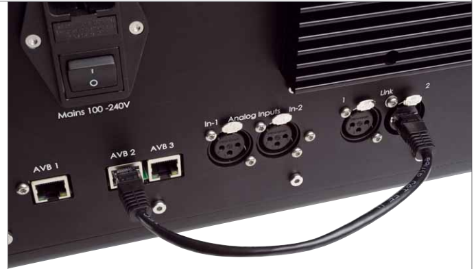
Der Subwoofer wird per Ethernet oder via analoge XLR-Buchsen in Betrieb genommen. Er baut seinen eigenen „Hot Spot“ für die Steuerung via Tablet auf
